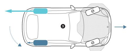
Situation 3: Der Fahrer möchte in eine Linkskurve fahren, aber die Vorderräder rutschen weg. Das Auto fährt geradeaus (Pfeil vorne). Die Software entlastet die Vorderräder und bremst das linke Hinterrad wesentlich stärker ab als das rechte, um einen Drall in die Kurve zu erzeugen (gestrichelter Pfeil).
