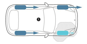
Situation 1: Der Fahrer möchte so stark wie möglich beschleunigen. Das rechte Vorderrad hat wenig Reibung (zum Beispiel wegen einer Pfütze oder Eis) und fängt an, durchzudrehen. Die Antriebsmomente werden darum auf die andere Seite und nach hinten verteilt (dunkle Pfeile).
