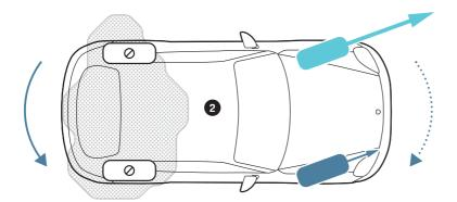
Situation 2: Das Auto fährt in einer Linkskurve. Die hinteren Räder überqueren eine glatte Stelle, sodass das Fahrzeug mit der Hinterachse wegrutscht (durchgezogener Pfeil). Die Software nimmt sämtliche Antriebsmomente von den hinteren Rädern, um ihnen die Arbeit zu erleichtern. Zusätzlich schiebt sie sehr viel Moment nach vorne links, um einen Drall zu erzeugen, der dem Wegrutschen entgegenwirkt (gestrichelter Pfeil).
